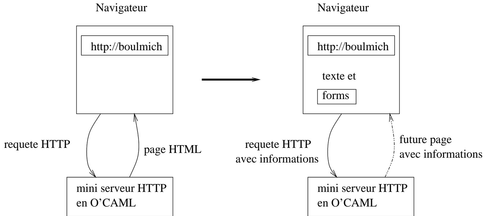
Figure 2: Communication entre un navigateur et un serveur O'Caml
