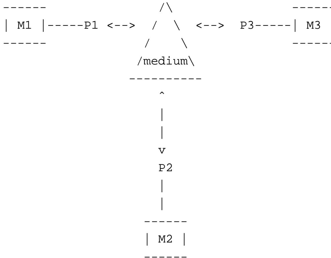
La difficulté de ce modèle provient de l'implantation du medium. Les programmes s'en chargeant s'appellent des *protocoles*.
