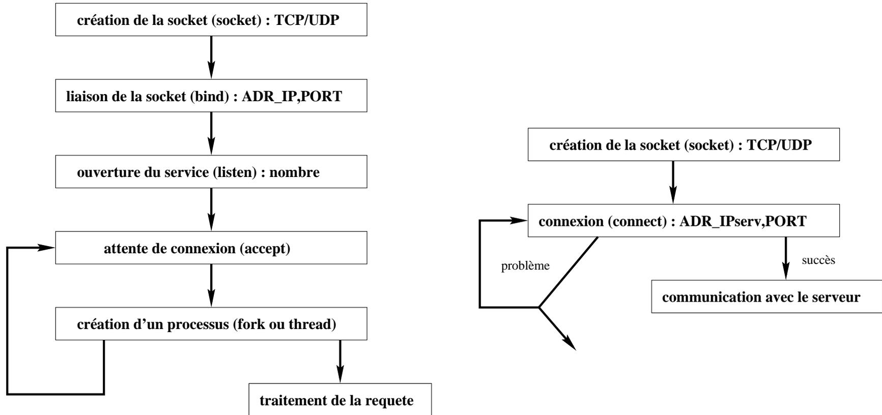
Figure 1: Schéma des actions d'un serveur et d'un client
