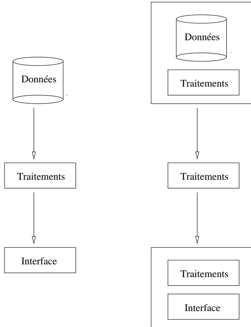
Différentes architectures de clients-serveurs : Chaque niveau peut être implanté sur des machines différentes. L'interface utilisateur s'exécute sur les machines des utilisateurs de l'application
