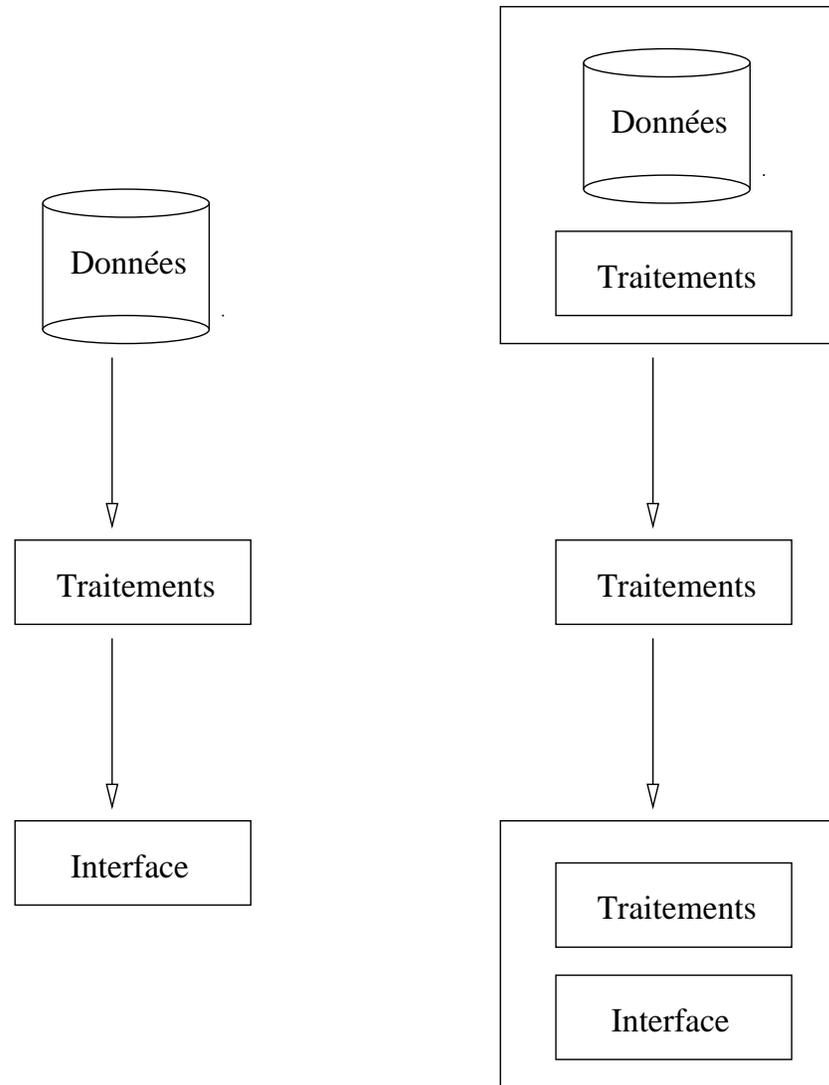
Chaque niveau peut être implanté sur des machines différentes. L'interface utilisateur s'exécute sur les machines des utilisateurs de l'application.
